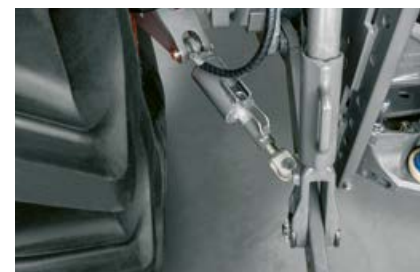
De als optie leverbare hydraulische zijstabilisatoren zorgen voor meer veiligheid en verlichten het werk.
