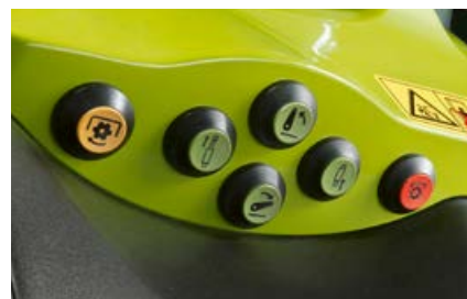
Externe bedieningselementen voor de achterhefinrichting, aftakas en regelventiel naar keuze
