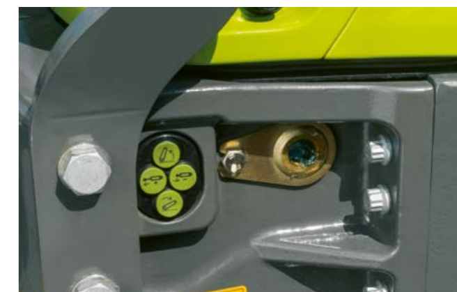
Elektronicky ovládanými rozvaděči může být čelní zvedací závěs a přídavný rozvaděč ovládan také externě.
