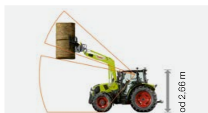
Kabina s vysokou střechou a s proskleným střešním oknem: světlá výška až 2,66 m.
