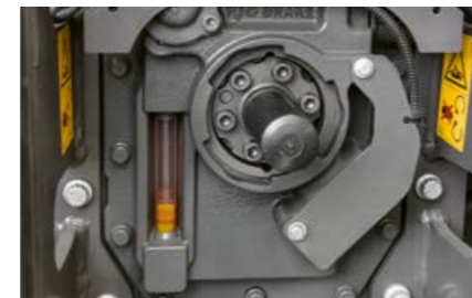
Stav oleje v převodovce a hydraulice můžete zkontrolovat přes průzor vedle vývodového hřídele.
