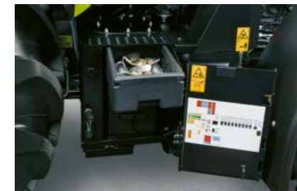
Na pravé straně v nástupních schodkách najdete dobře přístupnou baterii, přihrádku na náradí a přípojku stlačeného vzduchu.
