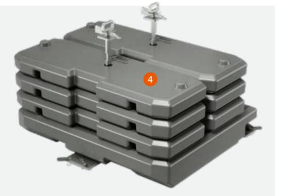
Ballastierung am Heck mit bis zu 3.400 kg möglich.
