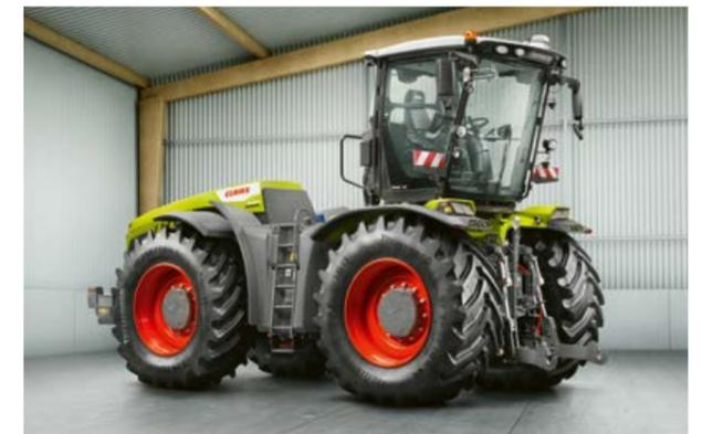
Der TRAC VC verfügt über die komfortabelste Rückfahreinrichtung auf dem Markt. Seine Kabine lässt sich in weniger als 30 Sekunden um 180° drehen.
