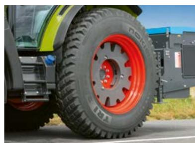
Pode aplicar até 270 kg de lastro na roda traseira esquerda para compensar o peso do braço da lança. Deste modo, tem sempre estabilidade e segurança em movimento.
