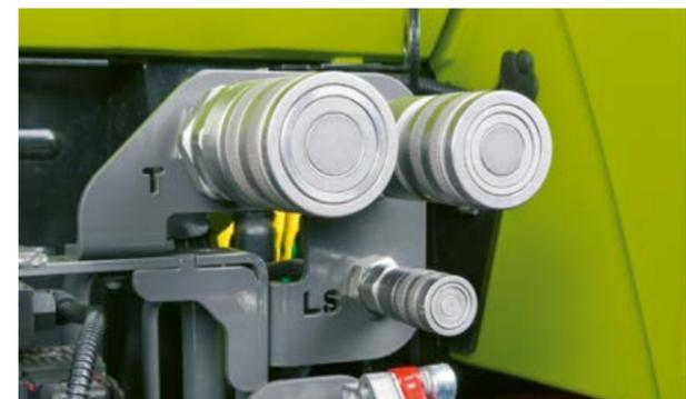
No caso de alfaias com unidades de comando próprias, existe na traseira a conexão Power-Beyond para o circuito Load-Sensing. Esta controla o consumo de óleo da própria alfaia, sem circulação permanente de óleo.
