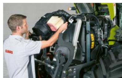
Filtro de ar do motor incorporado diante dos refrigeradores, pode ser limpo facilmente.
