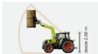
Cabina PANORAMIC com vidro dianteiro até ao teto de abrir: altura máxima a partir de 2,66 m.
