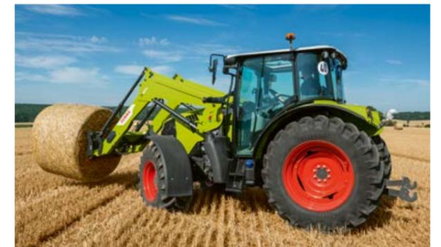
No modo dependente do ângulo de direção, a desmultiplicação da direção em deslocação em linha reta reduz-se fortemente. A direção torna-se, assim, mais sensível. Quanto mais forte for a direção do condutor, mais rápido reage a direção. Ideal, por exemplo, para trabalhar com o carregador frontal. O condutor consegue, ainda assim, manobrar em linha reta com sensibilidade e com rapidez.
