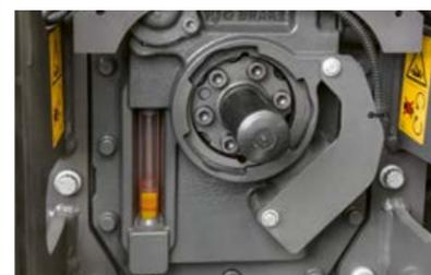
Pode controlar o nível de óleo da caixa de velocidades e do sistema hidráulico através de um visor de observação, junto à tomada de força.
