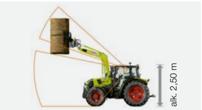
Matalakatto-ohjaamo lasikattoluukulla: Alituskorkeus alk. 2,50 m.
