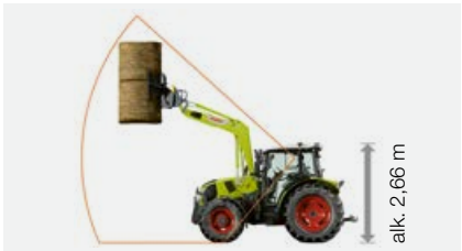
PANORAMIC ohjaamo jonka tuulilasi jatkuu katolle ikkunan muodossa: Alituskorkeus alk. 2,66 m.
