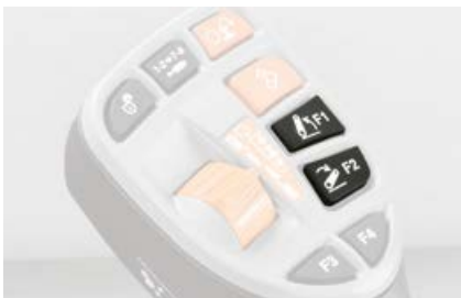
De achterhefinrichting kan niet alleen op de zijconsole worden bediend maar ook met de multifunctionele hendel.
