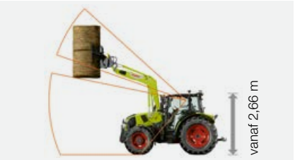
Cabine met hoog dak met glazen dakluik: doorrijhoogte vanaf 2,66 m.
