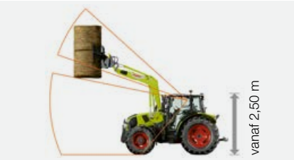
Cabine met verlaagd dak: doorrijhoogte vanaf 2,50 m.
