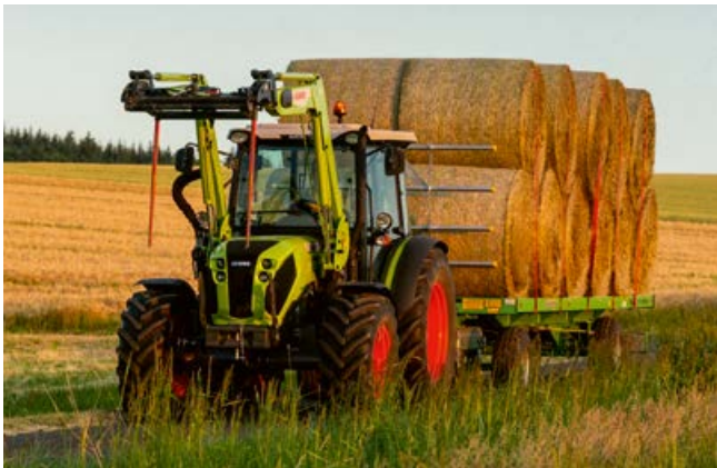
Koncepcja dołączanej konsoli pozwala na późniejsze bezproblemowe doposażenie w ładowacz czołowy CLAAS.
