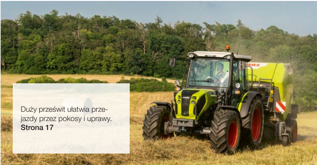
Ogumienie 34" oraz obciążenie użytkowe wynoszące niemal 2 t umożliwiają zastosowanie szerszych i cięższych przyrządów roboczych. Strona 16
