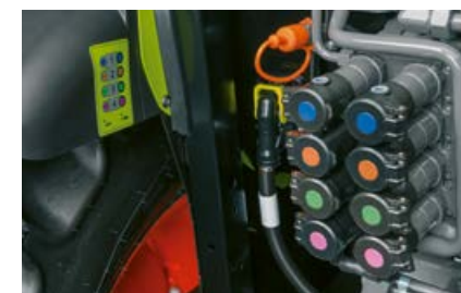
Przyłącza z tyłu można łatwo rozpoznać dzięki oznaczeniu kolorami oraz nalepkom umieszczonym w pobliżu.
