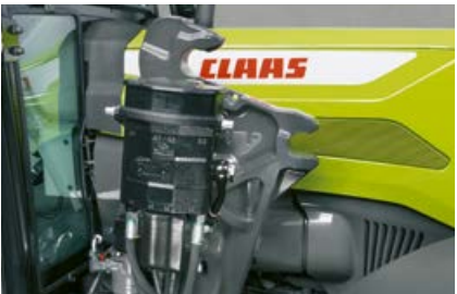
System FITLOCK do szybkiego zakładania ładowacza oraz szybkozłącze MACH do połączeń elektrycznych i hydraulicznych.
