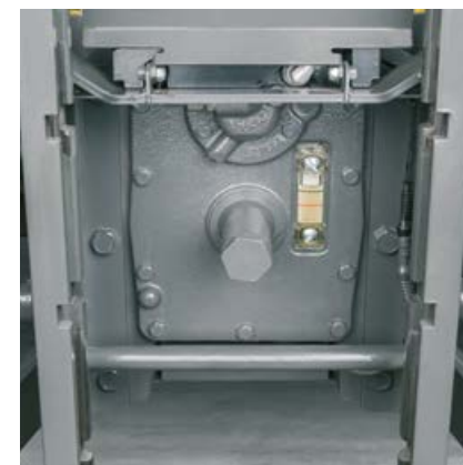
Poziom oleju przekładni i hydrauliki można kontrolować przez wżernik obok tylnej końcówki WOM.
