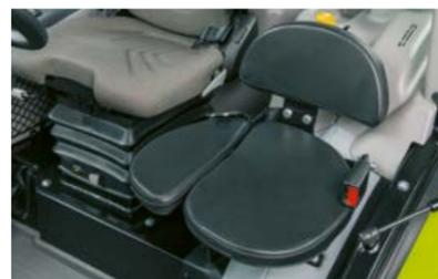
La amplia superficie de asiento ofrece un trayecto cómodo en el asiento del instructor. El cinturón integrado con mecanismo retráctil da una seguridad adicional.
