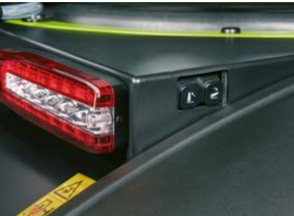
Regolazione della capacità di traino, velocità di abbassamento e limitazione dell'altezza di sollevamento possono essere regolate comodamente sulla console destra
