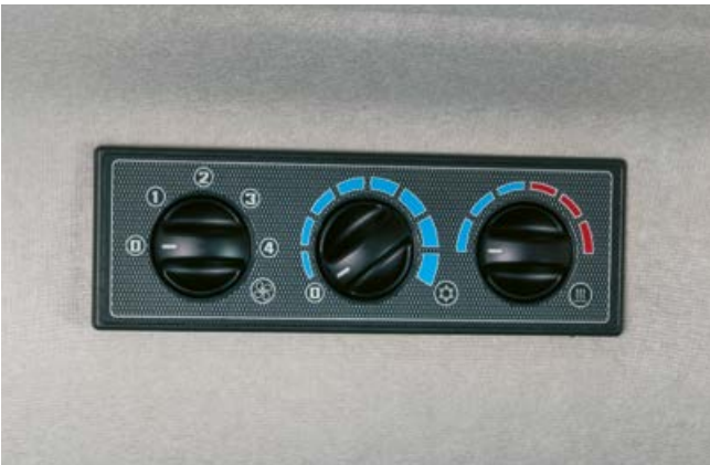
I comandi dell'impianto di ventilazione si trovano sul lato destro del tetto e sono facilmente raggiungibili.
