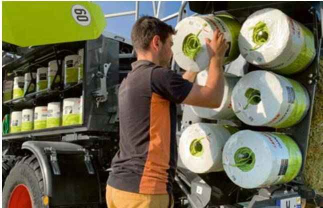
อุปกรณ์เสริม: ช้องจัดเก็บม้วนเชือกเสริม 12 ม้วน เพียงพอสำหรับมัดก้อนฟาง 350-400 ก้อนตามขนาดม้วนเชือกจริง
