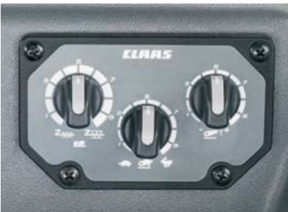
Zugkraftregelung, Senkgeschwindigkeit und Aushubbegrenzung stellen Sie komfortabel an der rechten Konsole ein.
