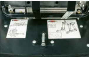
Під капотом двигуна розташована схема точок змащування, що спрощує виконання обслуговування.
