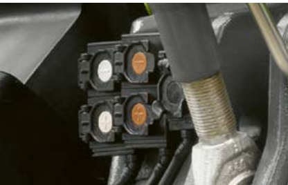
У комбінації з передньою навіскою спереду доступні до чотирьох роз'ємів під'єднання та одна лінія прямого зливу. Ідеальний варіант для передньонавісного насінневого бункера або відвала.
