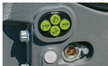
Зовнішнє керування передньою навіскою та одна секція гідророзподільника в комплектації CEBIS.
