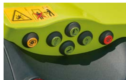
Зовнішнє керування заднім ВВП на обох крилах.
