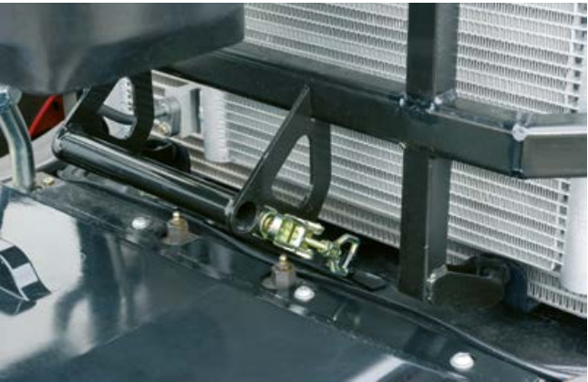
Точки змащування переднього моста розташовані перед блоком радіаторів — для оптимальної доступності.
