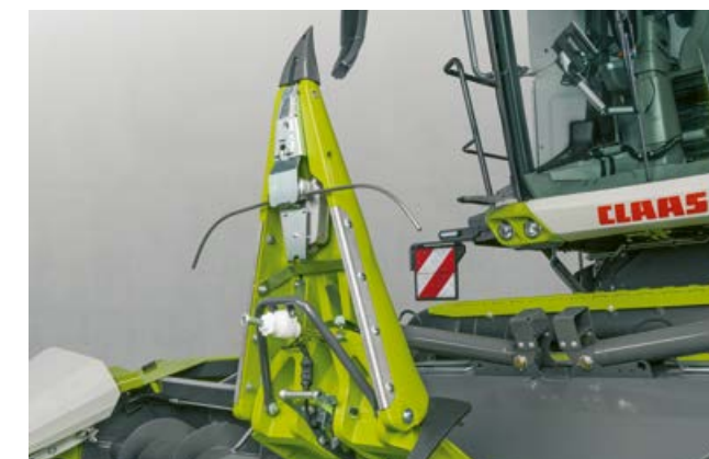
Два опипващи елемента следят всеки царевичен ред.
