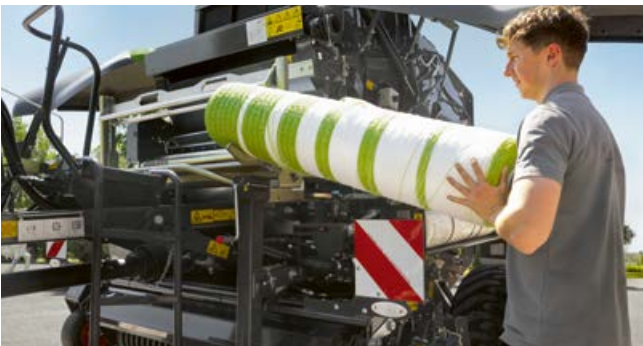
Det nya systemet för nätlindning på VARIANT 500 är placerat 25 cm lägre för att underlätta rengöring av nätrullen under nätbromsen.
