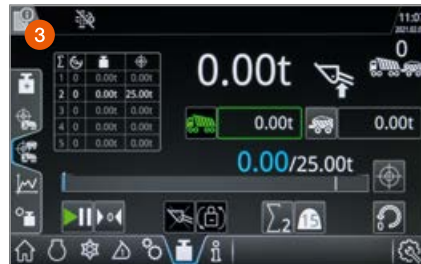
Vågssystemet registrerar och dokumenterar den ackumulerade vikten för hanterad mängd under arbetspasset.
