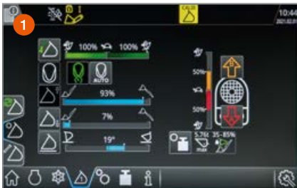
Begränsning av lyfthöjd och sänkdjup sparar de idealiska lägena för närhet till marken och för rätt tippningshöjd.
