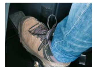
Broms-/inch-pedal med funktion för temporär hastighetsminskning.
