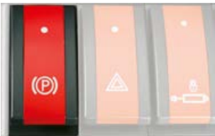
Le bouton permet d'activer le frein de parking manuellement.
