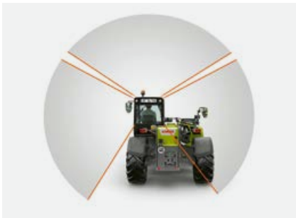
Vue dégagée vers l'arrière grâce à l'articulation basse du bras télescopique – pour plus de sécurité au travail.
