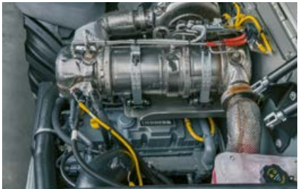
Le filtre à particules diesel se régénère automatiquement.
