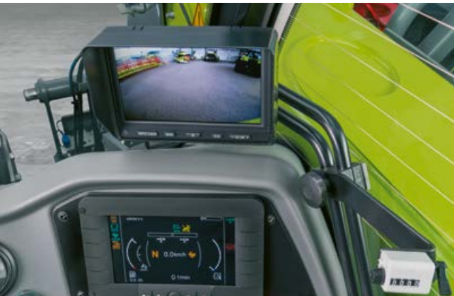
Les images des caméras avant et arrière sont diffusées sur l'écran de la cabine.
