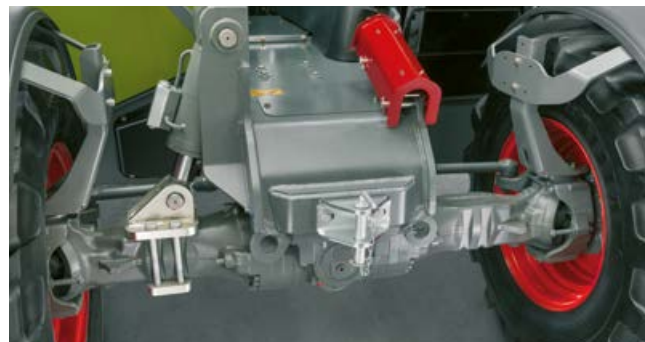
Sécurité renforcée au champ avec la compensation de dévers hydraulique.
