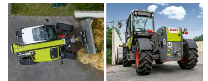
Un gain de précision grâce à la marche en crabe à commande manuelle.
