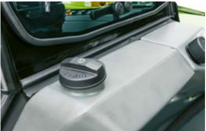
Réservoir de carburant verrouillable derrière la cabine.
