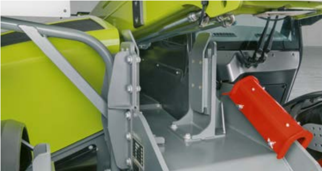
Guidage latéral du bras télescopique disponible pour tous les modèles SCORPION.
