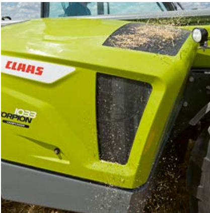
Prévention de l'encrassement du radiateur grâce au ventilateur réversible.
