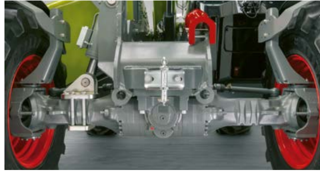
Châssis avec compensation de dévers hydraulique.
