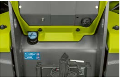
Bouchon de remplissage du réservoir d'AdBlue® facilement accessible pour une dépollution efficace des gaz d'échappement.
