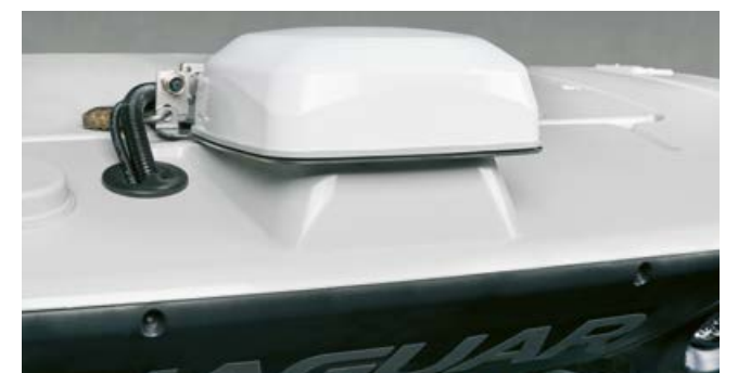
SAT 900 antena un uztvērējs vienā blokā – ar aizsardzību pret zādzību
