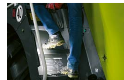
LED-lygterne på trinene giver sikker indstigning i komfortkabinen.
