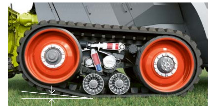
66 % kontaktflade: Løberullen hæves op til 100 mm.
