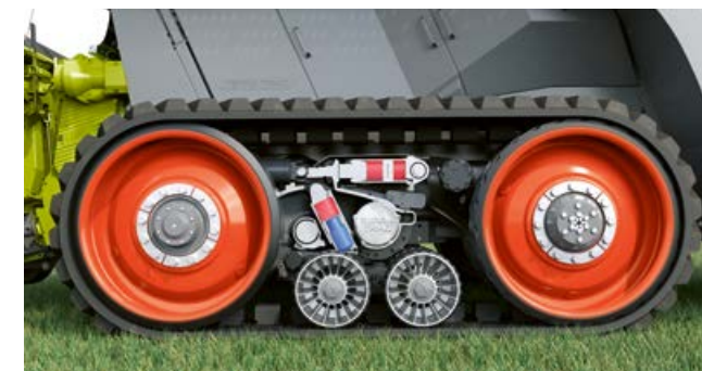
100 % kontaktflade: Løberullen har fuld kontakt med jorden.
