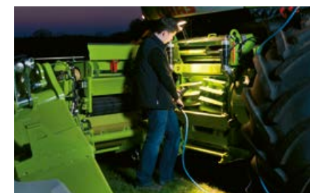
QUICK ACCESS giver mulighed for inspektion af snitteraggregaterne på få minutter.
