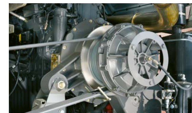
Brzda toku materiálu QUICK STOP
