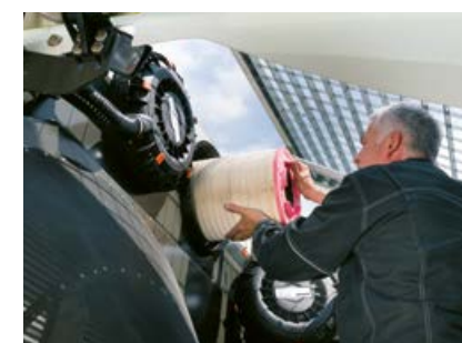
Výměna vzduchového filtru bez použití nářadí
