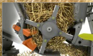
Ellenkés és behajtható dörzselem a SPECIAL CUT szalmaszecskázóban.
