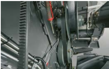
Peksutrumli ajam, millel on kaks hõlpsalt seadistatavat pöörlemiskiiruse vahemikku.
