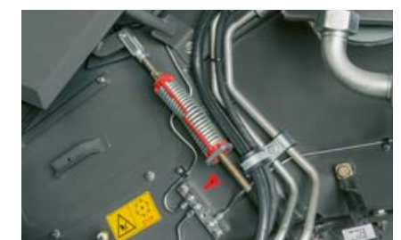
Kõik määridepunktid on selgelt tähistatud ja tsentraalsetele määrdepaneelidele koondatud.
