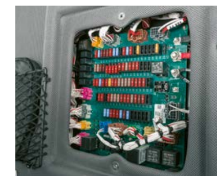
Az elektronika egybe van csoportosítva és könnyen hozzáférhető.
