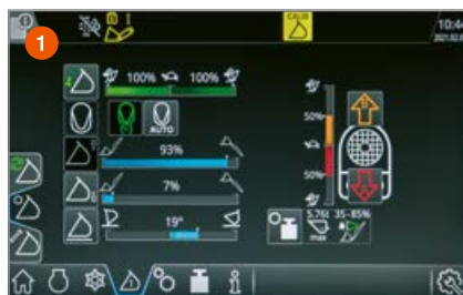
Az emelési és süllyesztési magasságkorlátozás tárolja az ideális talajközeli pozíciót és az ideális dőlésmagasságot.
