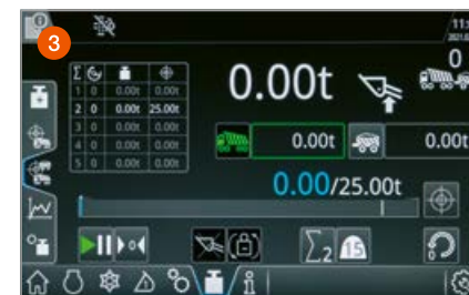
A mérlegrendszer pontosan méri és dokumentálja a naponta mozgatott mennyiséget.
