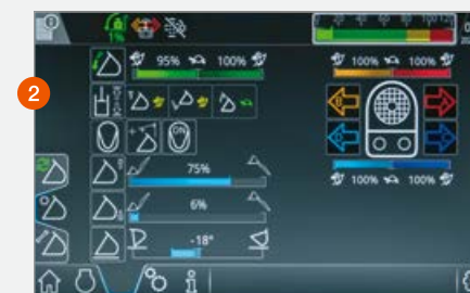
Az emelési magasság és a süllyesztési mélység határai megjelennek a 9 collos érintőképernyőn.
