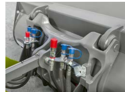
Minden csatlakozó jól elérhető és védett helyen az eszköztartón található (956)
