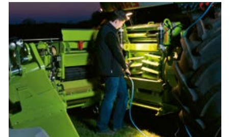
QUICK ACCESS gör inspektion av hackaggregatet möjlig på några minuter.
