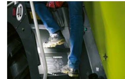
LED belysning på fotstegen ger säkerhet när man antrar/lämnar komforthytten.
