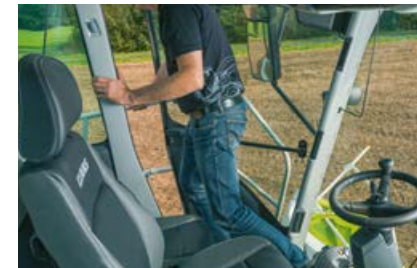
Säkerhetskontakt i förarsätet kopplar automatiskt ur frontaggregat och huvuddrivning.
