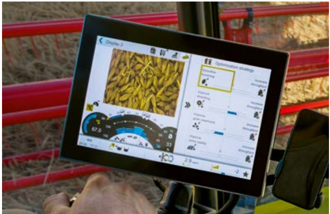
Intelligente Steuerung durch CEMOS AUTOMATIC über CEBIS
