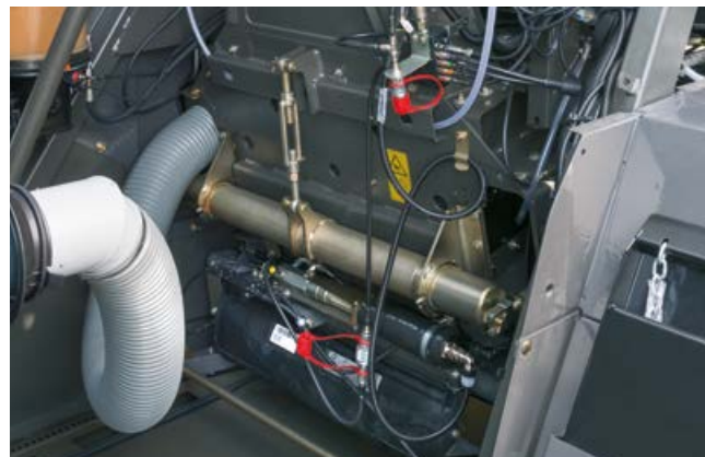
Mechanische Spalteinstellung des Auswurfbeschleunigers
