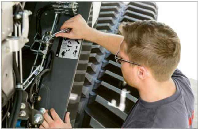
Plages de régimes du réducteur de régime batteur (deux plages) sélectionnables manuellement via une vanne de commutation hydraulique.
