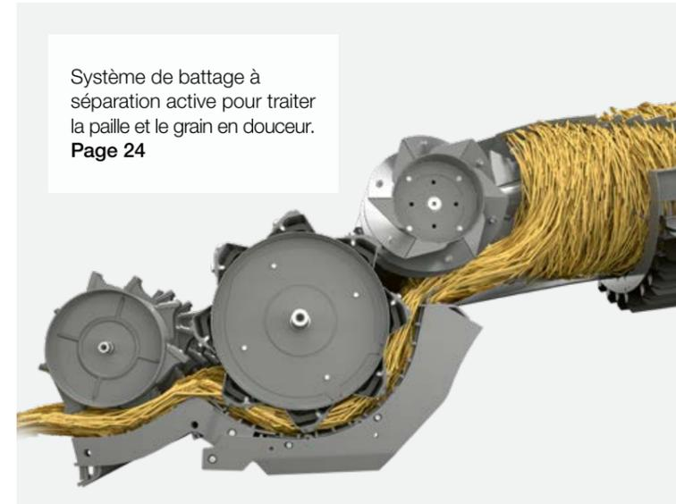
Système de battage à séparation active pour traiter la paille et le grain en douceur.
