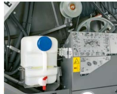
Bancs de graissage facilement accessibles.
