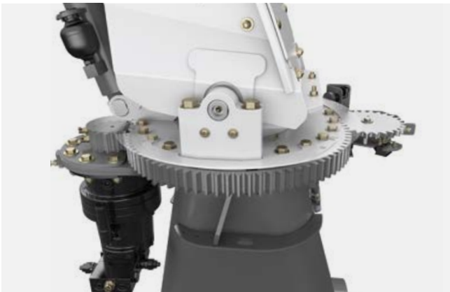
Robuuste draaikrans voor gebruik op hellingen of bij hoge werksnelheden
