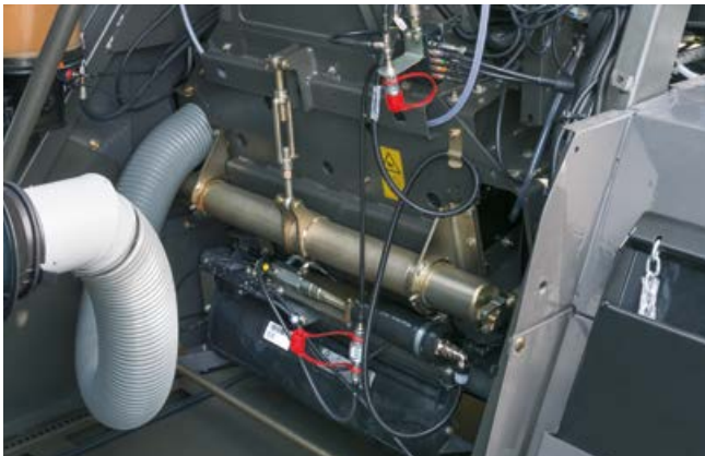
Mechanische afstandsinstelling van de uitwerpversneller
