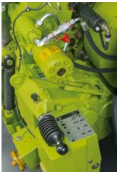
Voor verschillende markteisen kunnen de schakeltrappen voor de bijbehorende haksellengtes aan de eisen van de klant worden aangepast.
