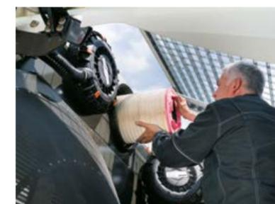
Sostituzione senza attrezzi del filtro dell'aria.
