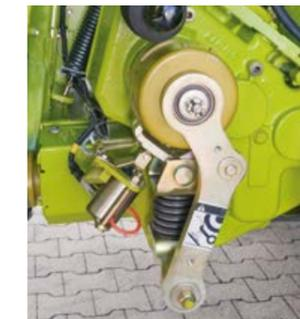
Frizione di disinnesto del rilevatore di metalli.
