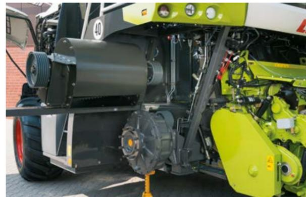
Semplice montaggio e smontaggio dell'acceleratore.
