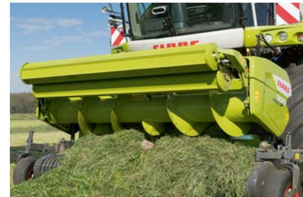
**Rilevatore di sassi STOP ROCK.**
