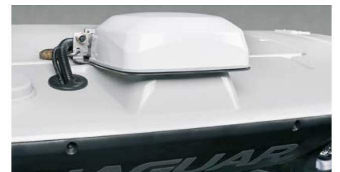
SAT 900 antenne en ontvanger gecombineerd, met diefstalbeveiliging
