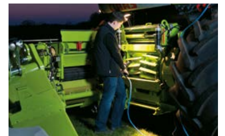
QUICK ACCESS maakt inspectie van de hakseltrommel in slechts enkele minuten mogelijk.
