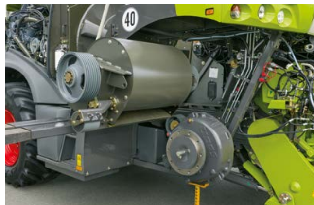
Eenvoudig in- en uitbouwen van de uitwerpversneller
