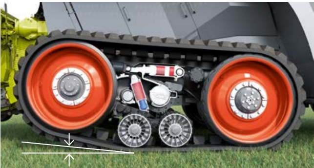
66% contactoppervlak: het loopwiel wordt tot 100 mm opgeheven.
