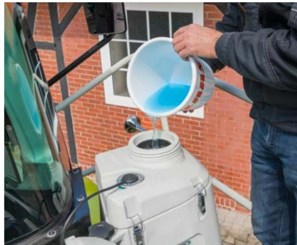
Remplissage du réservoir d'additifs d'ensilage
