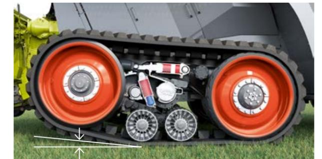
Surface de contact au sol réduite de 66 % : une partie des chenilles se relève jusqu'à 100 mm.
