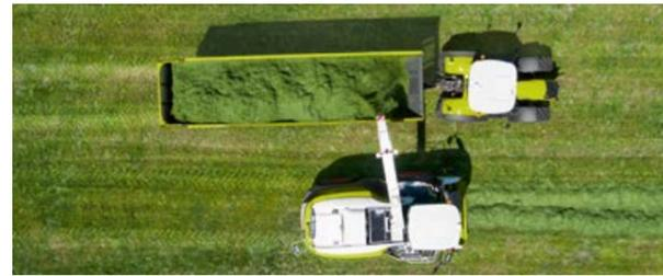
Deux positions finales mémorisées vous facilitent le remplissage en bout de champ. La goulotte d'éjection revient automatiquement en position de stationnement par simple pression sur un bouton.
