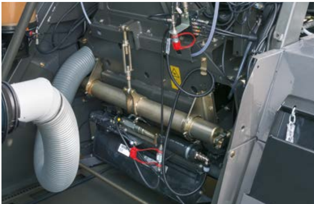
Réglage mécanique de l'écartement de l'accélérateur d'éjection
