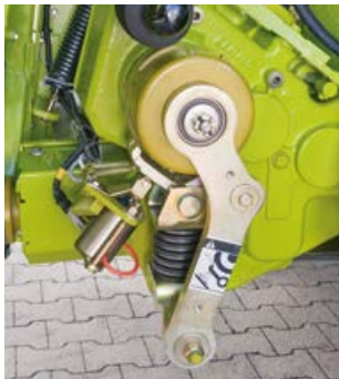
Limiteur de couple du détecteur de métal
