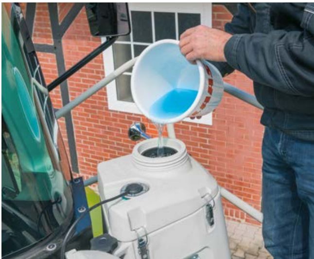
Remplissage du réservoir d'additifs d'ensilage
