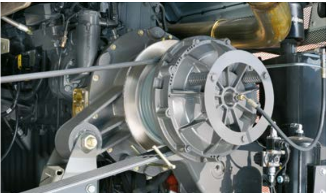
Décélération du flux de récolte avec le QUICK STOP
