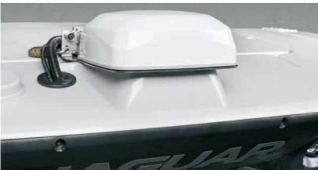
Récepteur et antenne SAT 900 dans un boîtier avec protection antiviol
