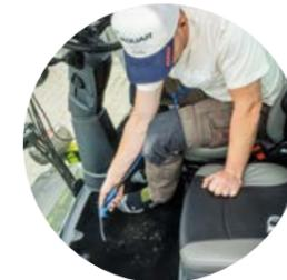
Druckluftpistole in der Kabine zum Reinigen
