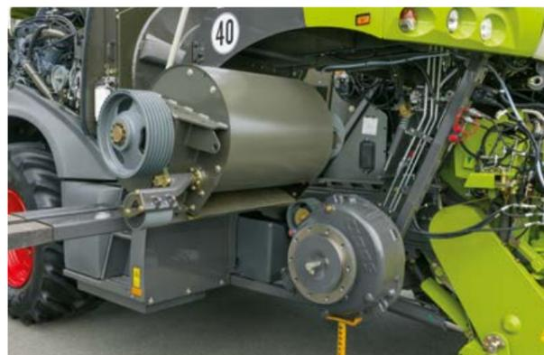
Einfacher Aus- und Einbau des Beschleunigers
