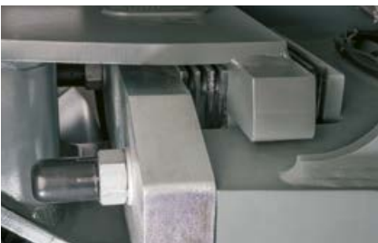
Ammortizzatori in gomma nel giunto articolato oscillante aumentano il comfort di lavoro.
