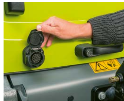
13-pólová zásuvka na zadní straně pro připojení přívěsu
