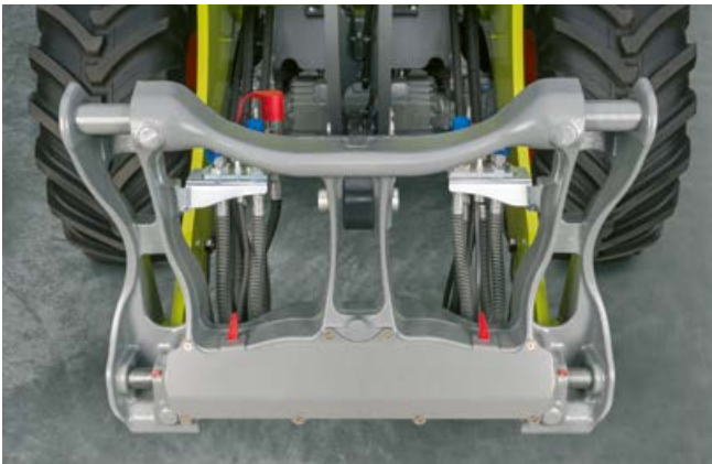
Robustní držák nářadí (956). – Velice odolný odlitek – Ložiska bez vůle pro náročný provoz – Hydraulické zajišťovací čepy
