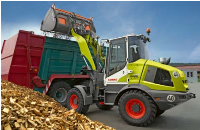
High-lift - prodloužený výložník (956 / 644). Výšky při vyklápění až do 3,64 m (956) resp. 3,45 m (644) Vám dovolují jednoduchou a rychlou nakládku nákladních automobilů a velkoobjemových vozů s vysokými okraji.
