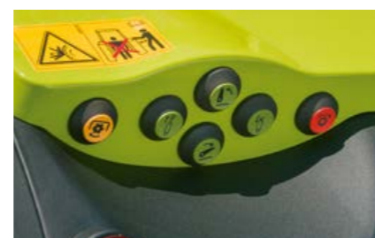
Externe bediening van de achter-aftakas op beide spatborden.
