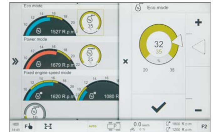
Instelling van de motordrukking voor "Eco" en "Power" bij geactiveerd motortoerental geheugen.
