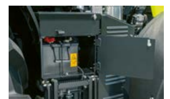
Aan de rechterzijde onder de opstap bevindt zich de goed bereikbare accu.
