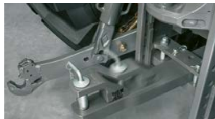
De treklat heeft verschillende posities. In uitgetrokken positie is de wendbaarheid beter.
