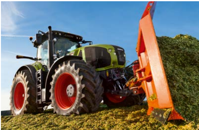
Jusqu'à deux distributeurs à double effet et un retour libre sont disponibles à l'avant avec le relevage avant. Un équipement idéal pour une trémie ou une lame montée sur le relevage avant.
