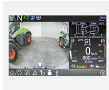
La telecamera di retromarcia si accende automaticamente quando viene innestata la retromarcia.
