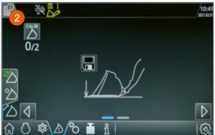
Il rientro della pala richiama automaticamente due posizioni della benna memorizzate.
