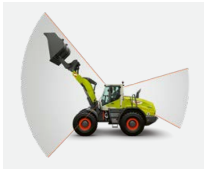
I sottili montanti laterali consentono un'ottima visuale sul porta-attrezzi.
