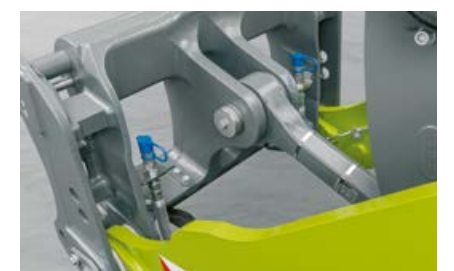
Predisposizione per due ulteriori innesti idraulici.
