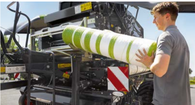
Новая система увязки сеткой серии VARIANT 500 на 25 см глубже, что позволяет легко очищать рулон сетки под тормозом.
