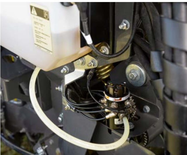
Lubrification permanente des chaînes.
