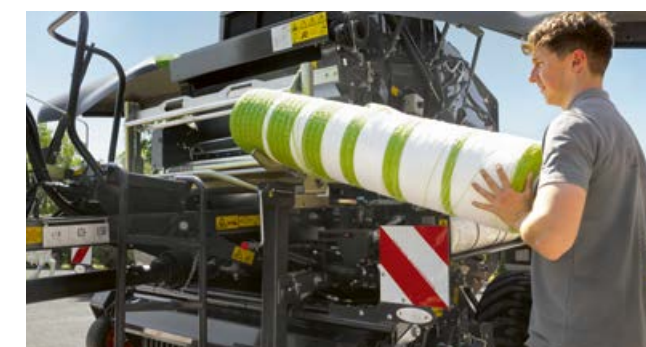
Nový systém vázání do sítě lisu VARIANT 500 je umístěn o 25 cm níže, aby se dala snadno čistit role sítě pod brzdou sítě.
