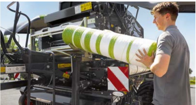
A VARIANT 500 sorozat új hálókötése 25 cm-rel lejjebb helyezkedik el, hogy könnyen cserélhető legyen a hálótékercs.
