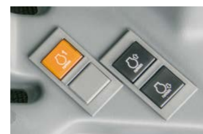
ELIOS'illa teet voimanottokäyttöiset työt erityisen helposti - vakiona olevan moottorin kierrosnopeusmuistin ansiosta.
