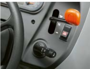
Vaihteistoon on vaihtoehtoisesti saatavissa mekaaninen alentaja oikealle, ohjaus- pyörän vieressä tai helppokäyttöinen 2-nopeuksinen powershift vaihde, jota hal- litaan vaihdevivusta.
