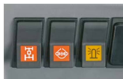
4-vedon ja tasauspyörästön lukon sähkökytkentä: Nopeudesta riippuva turvapysäytys estää väärinkäytön.
