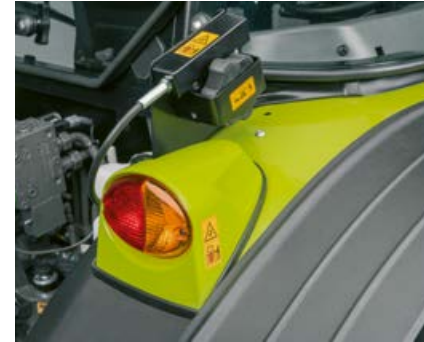
Mekaanista nostolaittehallintaa voidaan käyttää takana, ohjaamon ulkopuolella, työkonetyöskennän helpottamiseksi.
