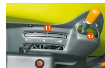
Voimanoton hydraulisesti tehostettu päälle kytkentä on vakiovaruste. REVERS SHIFT'illä varustetuissa traktoreissa elektroninen voimanoton päälle kytkentä on saatavissa lisävarusteena.
