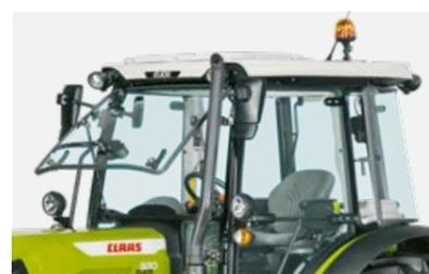
Para uma ventilação natural, é possível configurar o vidro frontal, o vidro traseiro e as janelas laterais.
