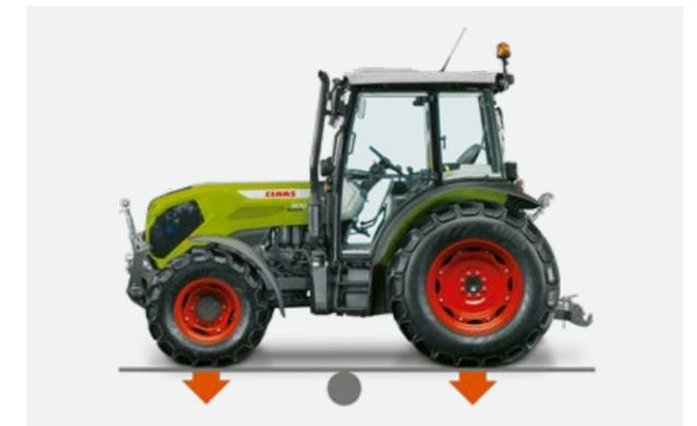
Para poder atravessar espaços verdes em parques ou instalações desportivas sem danificar o solo, a CLAAS fornece, facultativamente, pneus de relva Trelleborg com dimensões 600/55-26.5 na traseira e 400/55-22.5 na dianteira. Deste modo, as áreas com relva sensível ou solo húmido podem ser percorridas durante todo o ano sem causar danos no campo.
