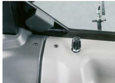
O débito máximo do distribuidor hidráulico mecânico n.º 3 pode ser limitado, a partir da cabina, por um manipulo.
