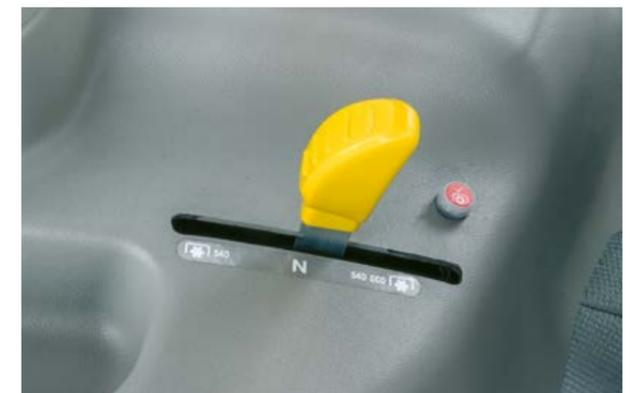
A acoplagem de tomada de força eletro-hidráulica regula um funcionamento suave consoante a alfaia engatada e protege o mecanismo.
