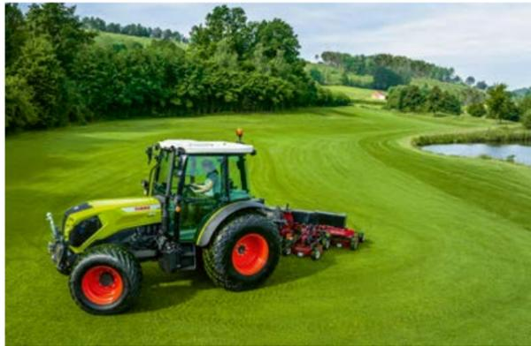
Especialmente em condições difíceis, como por exemplo em trabalhos em declives, o baixo centro de gravidade confere aos tratores da série ELIOS uma excelente estabilidade. Esta pode ser reforçada com uma largura máxima da bitola de 2.310 mm. Isto, juntamente com a distribuição equilibrada do peso, confere segurança. Com um baixo peso sem carga, a partir de 3,6 t, está em movimento de uma forma que é suave para o solo e eficiente em termos de combustível na estrada.
