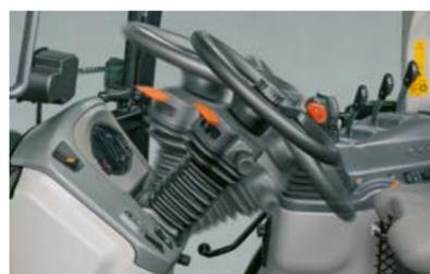
O condutor consegue uma posição sentada confortável com a coluna de direção regulável. Para uma deslocação ideal, é possível variar a inclinação e profundidade.
