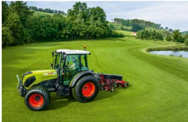
Especialmente en condiciones difíciles, como al trabajar en pendientes, un bajo centro de gravedad dota a los tractores de la serie ELIOS de una excelente estabilidad. Esta puede ser reforzada aún más con el ancho de vía máximo de 2.310 mm. Esto otorga, junto con el compensado reparto del peso, seguridad. Con un bajo peso en vacío a partir de 3,6 t avanza cuidando el suelo y ahorrando combustible.
