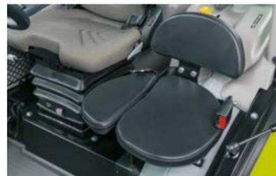
La amplia superficie de asiento ofrece un trayecto cómodo en el asiento del instructor. El cinturón integrado con mecanismo retráctil ofrece una seguridad adicional.
