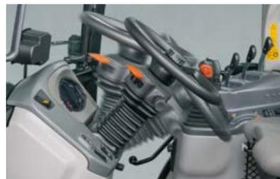
El operario obtiene una confortable posición de asiento con la columna de dirección regulable. Para una conducción óptima se pueden variar la inclinación y la profundidad.
