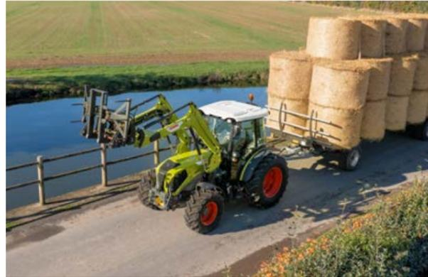
Mediante el concepto de soporte de montaje también se puede equipar sin problemas en un momento posterior un cargador frontal CLAAS.
