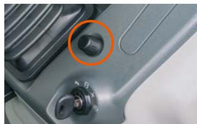
Con el botón giratorio navega confortablemente por el menú. Este se encuentra junto a la columna de dirección.
