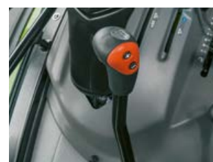
Postoji ili mehanički reduktor s desne strane upravljača ili udoban TWINSHIFT dvostruki power mjenjač, kojim se upravlja na ručici mjenjača.
