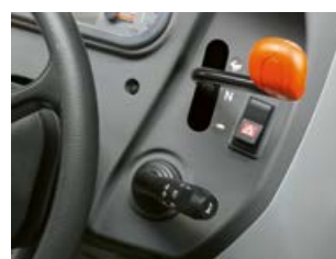
Postoji ili mehanički reduktor s desne strane upravljača ili udoban TWINSHIFT dvostruki power mjenjač, kojim se upravlja na ručici mjenjača.
