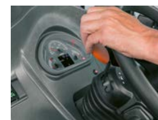
Reverzer je prikladno smješten lijevo od kola upravljača, elektronički s funkcijom REVERSHIFT ili mehanički.
