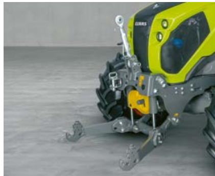
Opcijski prednji hidraulični podizač kapaciteta dizanja od 3,2 t i prednje priključno vratilo proširuju raspon primjene stroja ELIOS.
