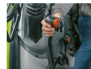
S opremom REVERSHIFT: elektroničkom spojkom se upravlja pritiskom gumba na ručici mjenjača.
