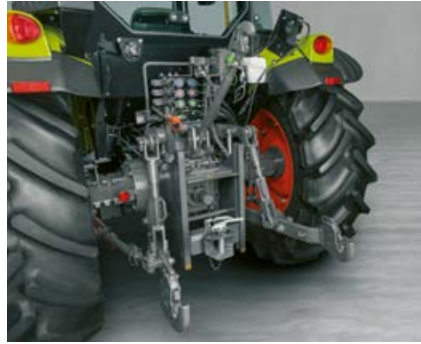
S maksimalnim kapacitetom podizanja od 3,2 t, ELIOS se dobro nosi s teškom svakodnevicom.
