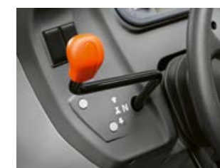
Reverzer je prikladno smješten lijevo od kola upravljača, elektronički s funkcijom REVERSHIFT ili mehanički.
