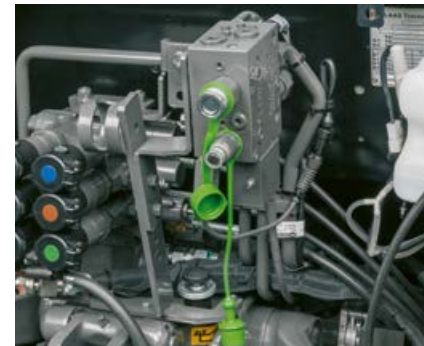
Uz hidrauličku dvovodnu kočnicu prikolice ostajete fleksibilni čak i tijekom transporta.
