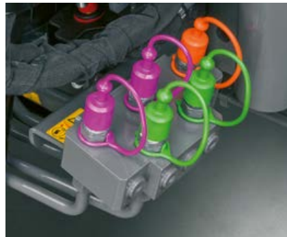
Sprijeđa desno na kabini dostupna su do četiri hidraulička priključka i slobodan povrat.
