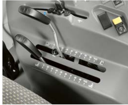
Rukovanje mehaničkom kontrolom stražnjeg hidrauličnog podizača ergonomski je smješteno desno od vozačevog sjedala.
