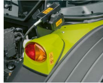
Mehaničkom kontrolom stražnjeg hidrauličnog podizača može se upravljati izvana sa stražnje strane za pričvršćivanje uređaja.
