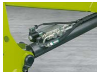
Tänu elektrilisele lülitamisele saate ohutusventiile FL-i ja FL C sarja puhul kombineerida SHOCK ELIMINATORi vibratsioonisummutusega.
