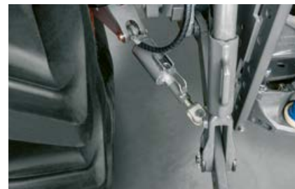
Lisävarusteena saatavat hydrauliset sivurajoittimet parantavat turvallisuutta ja helpottavat työtä.
